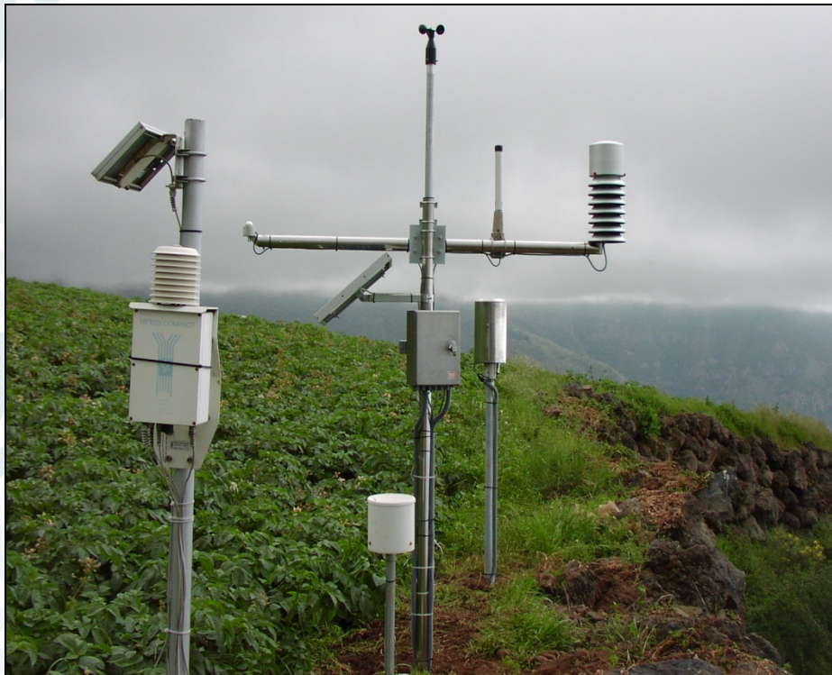
Estación meteorológica automática
