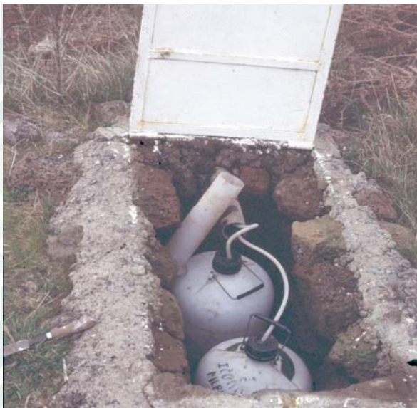
Hueco excavado en el suelo, depósitos graduados y probeta convencional de 1 l. de capacidad
