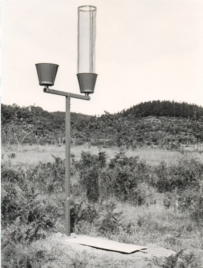
Pluviómetros totalizadores y captanieblas cilíndricos fabricados en las instal. de ICONA
